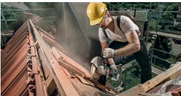
Der erste Akku-Winkelschleifer mit 230 mm Scheiben-Durchmesser.
