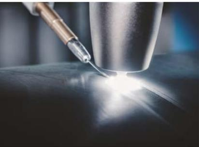
Arcline PP verbindet die Schweißnahtgüte des WIG-Schweißens mit hoher Produktivität.
