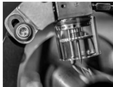
Neue Elektroden für Rohrschweißensätze.
