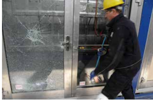
Einbruchversuch an der 2-flügeligen Aluminium-Vollpaniktür der Serie S6es in Widerstandsklasse RC4.
