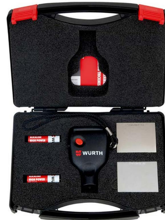
Das Messgerät Kombi von Würth eignet sich auf Stahl und Eisen (ferromagnetischen Metallen) und nicht magnetischen Metallen.
