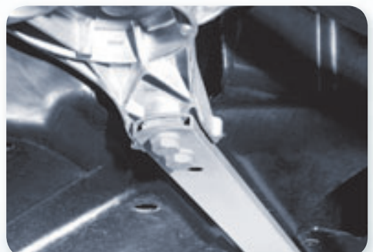
Unterbodenansicht BMW X 3: HT-verzinkte Zugstrebe
