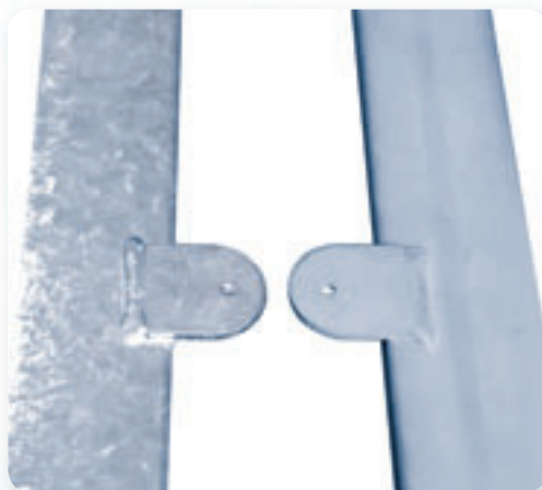
NT-Verzinkung mit verschlossener Bohrung
