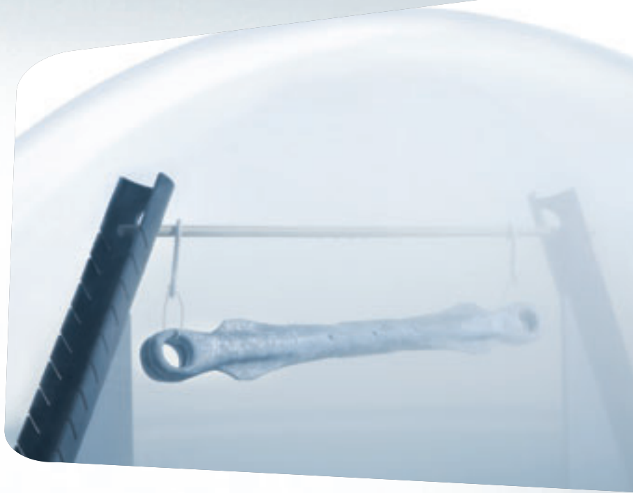
Salzprühanlage mit Prüfling
