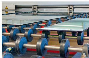
Glasfestmaße vor der Eintrittskammer in die Hochvakuum-Beschichtungsanlage.
