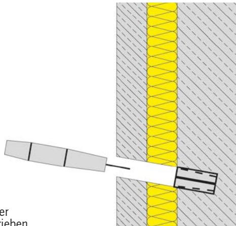
Der Doppelkonusbolzen wird in die in der Tragschicht liegende Sprezhülse eingetrieben.
