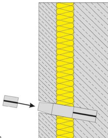
Zuletzt wird die kürzere Sprezhülse ebenfalls mit einem Setzadapter über den in der Wetterchale liegenden Anker getrieben. Rechts ist der fertig montierte EJOT KERI-Wetterschalenanker zu sehen.
