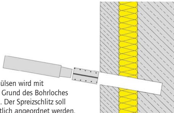
Die längere der beiden Sprezhülsen wird mit einem Setzadapter bis auf den Grund des Bohrloches in die Tragschicht eingetrieben. Der Spreizschlitz soll zur besseren Lastverteilung seitlich angeordnet werden.
