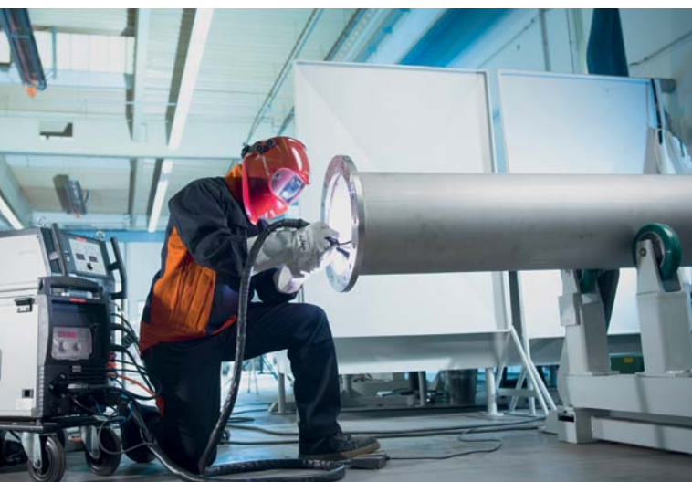
Die Hering AG hat ihre Rohr-Flansch-Verbindungen entweder mit E-Hand- oder der MIG/MAG-Schweißtechnik gefügt. Seit das WIG-Schweißen die E-Hand-Technik abgelöst hat, spart der Betrieb bis zu 50% Zeit. Seite 33
