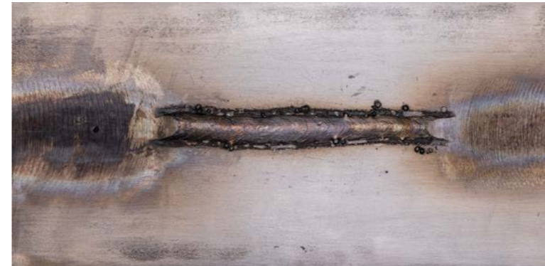
Konventionell entstehen Anlauffarben/Oxidation infolge eines hohen Wärmeeintrags.
