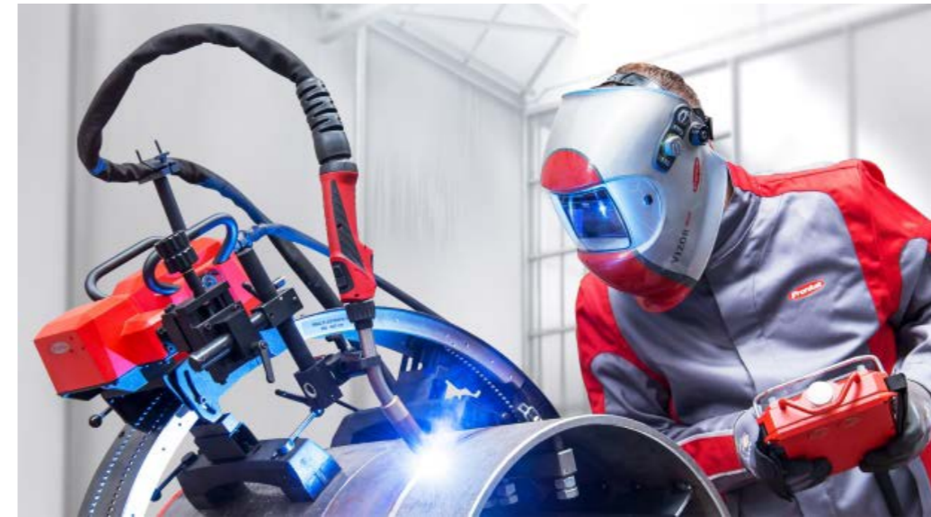
FlexTrack 45 Pro sorgt durch eine konstante Fahrgeschwindigkeit für reproduzierbare Schweißergebnisse.
