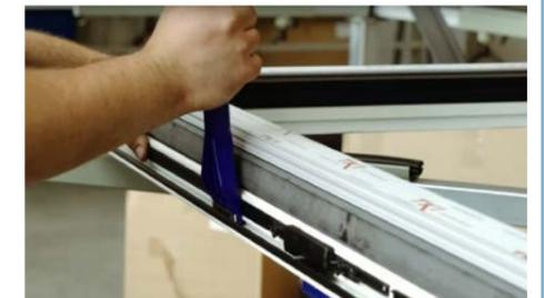
Mit einem Montagehebel werden die Beschläge direkt von außen frontal in die Beschlagnut eingesetzt.
