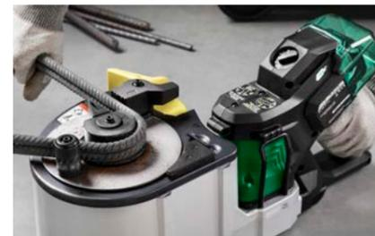
Akku-Schneide- und Biegegerät für Stahl von 10-16 mm.
