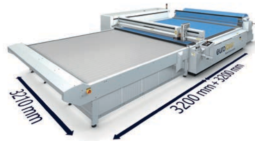
Die Lasersysteme bearbeiten großflächige Materialien bis zu 3,20 m Länge und Breite.
