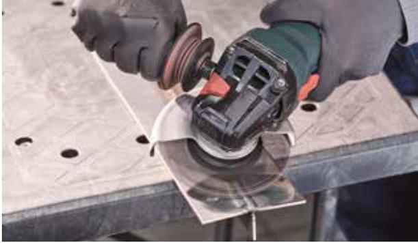
Mit der Schleifscheibe Vision Cool bleibt der Blick auf die Schweißnaht frei und die Hitzeentwicklung ist um ca. 50% reduziert.
