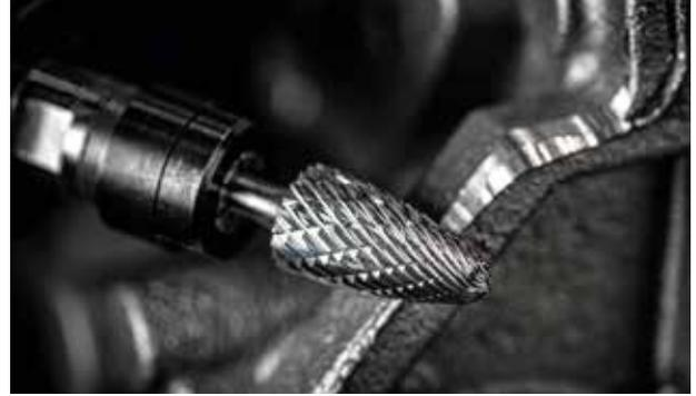
Mit der sogenannten Allround-Zahnung lassen sich 30% mehr Abtrag erreichen als mit einem kreuzverzahnten Hartmetallfrässtift.
