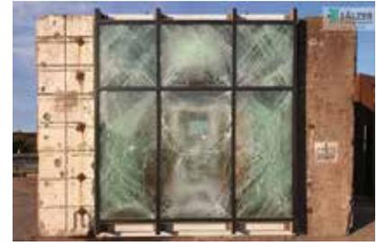
Die neue Hochsicherheitsfassade wurde bei einem Sprengtest mit 500 kg geprüft.
