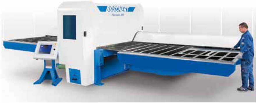
Die neue Generation Fiber-Laser schneidet Bleche mit einer Länge bis zu 10.000 mm.
