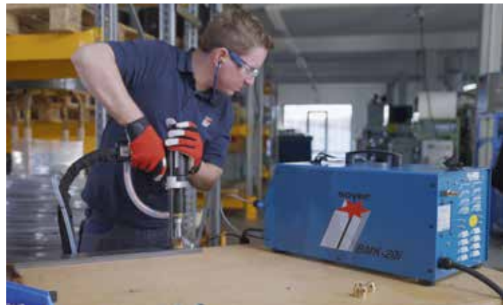
Das Gerät BMK-20i ist für große Bolzendurchmesser bis M16 geeignet.
