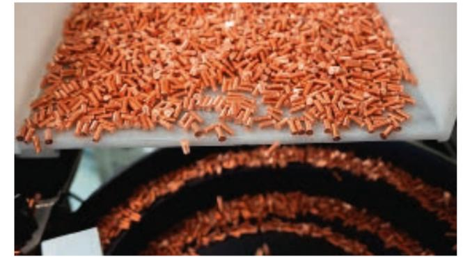
Neu: HZ-1 Bolzen mit einem Durchmesser von M6 bis M12 können vollautomatisch zugeführt werden.
