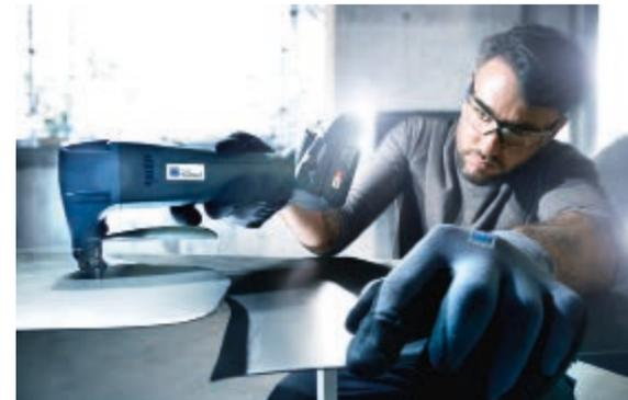
Die Schere S250 LiHD Akku trennt Flach- und Riffelblech sowie Drahtgitter.
