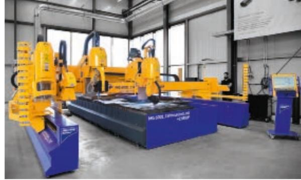
3D-Schneiden, Bohren und Fräsen ist an der multifunktionalen Baureihe MG inklusive Plasmarotator möglich.
