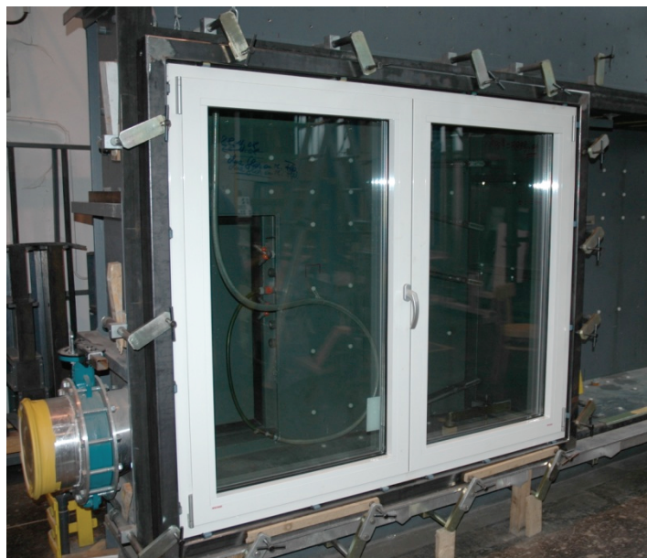
Abb. 7: Prüffenster 2 im Prüfstand
