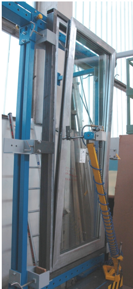
Abb. 8: Fenster 3 im Dauerfunktionsprüfstand
