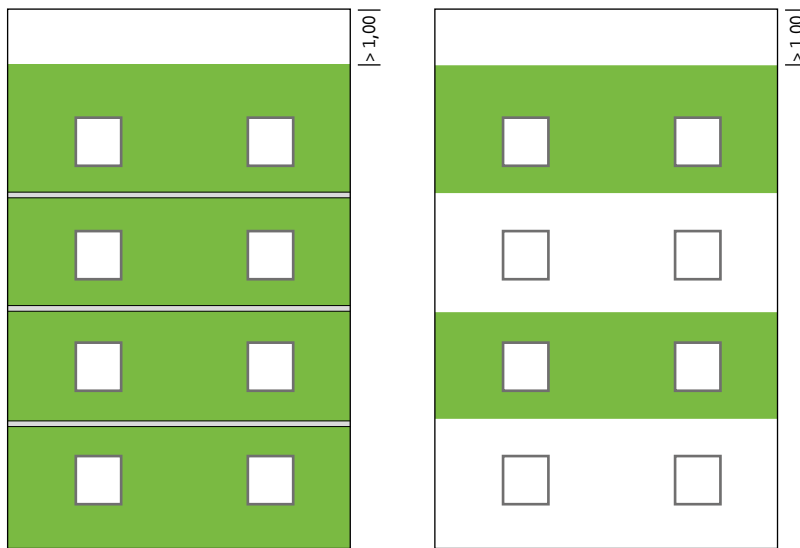
Abb. 3: Brandriegeln zwischen Geschossen oder unbepflanzte Geschosse gemäß [28]
