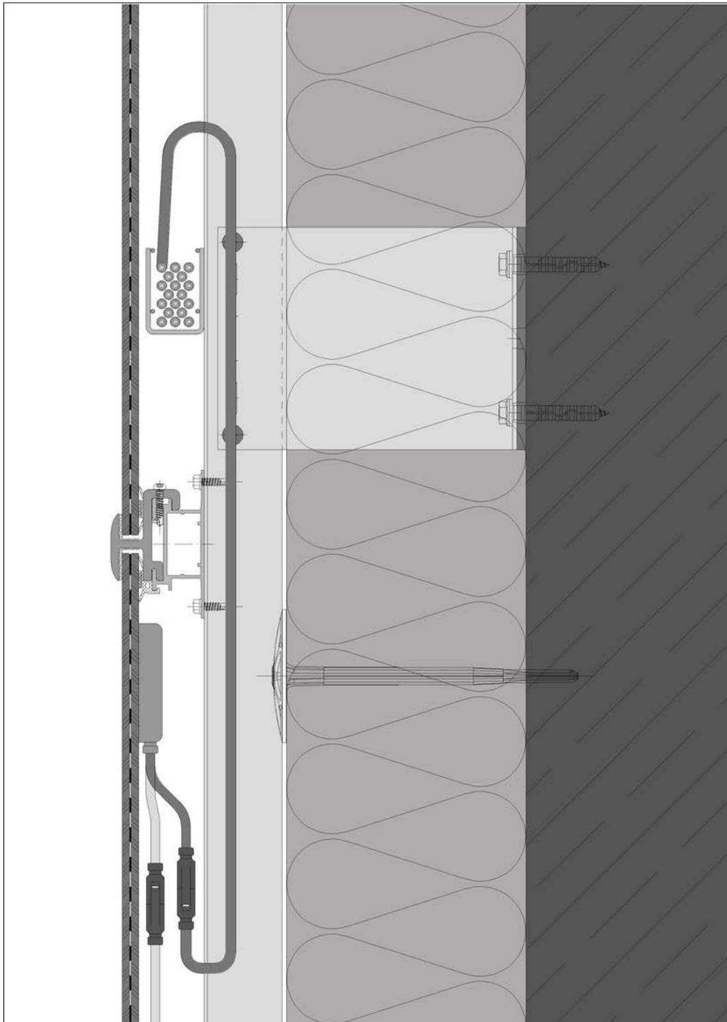
Abbildung 17: Punktförmige Lagerung (Quelle FVHF)
