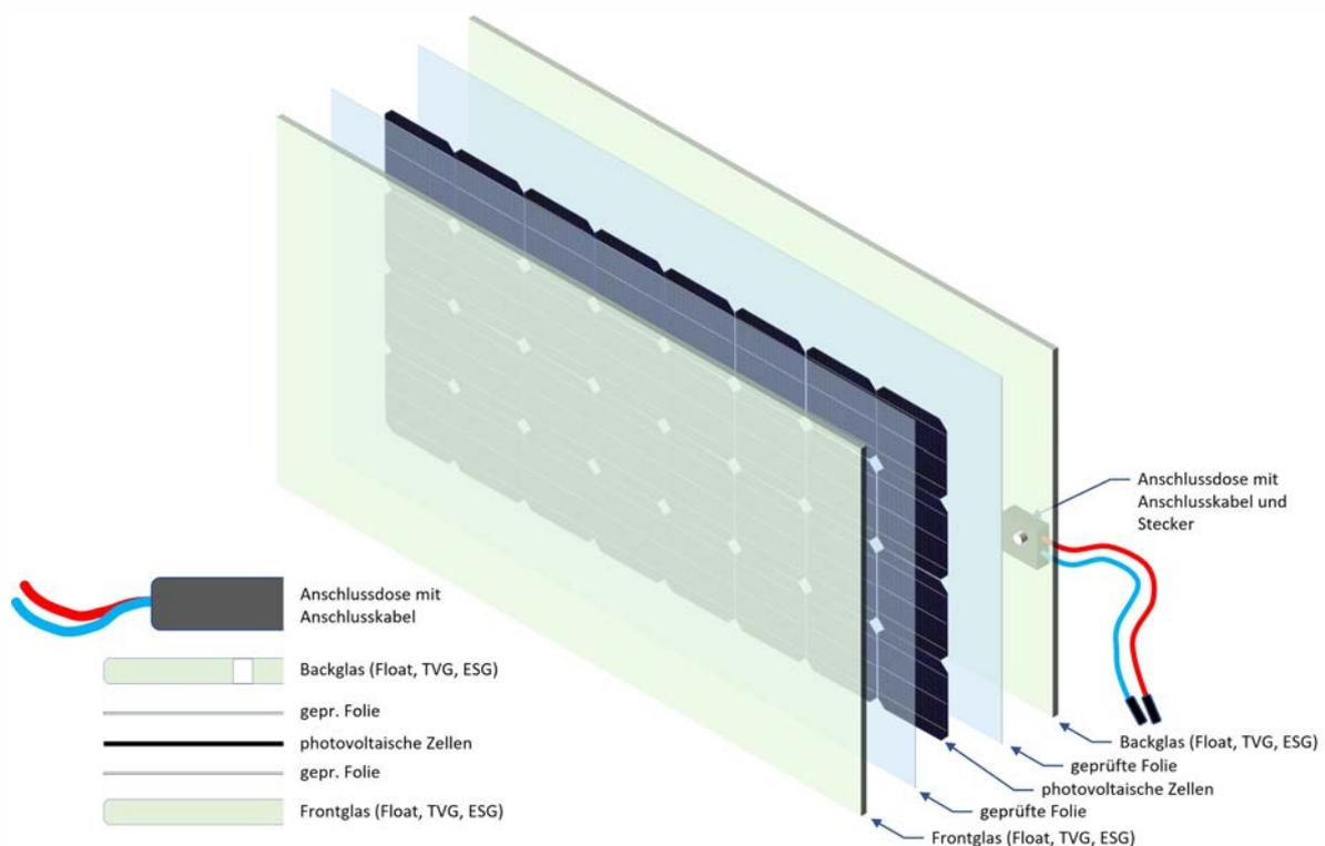
Abbildung 3: Aufbau kristallines Glas-Glas-Modul (Quelle FVHF)
