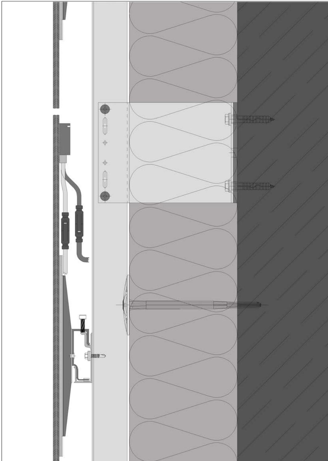
Abbildung 18: Nicht sichtbare Lagerung (Quelle FVHF)
