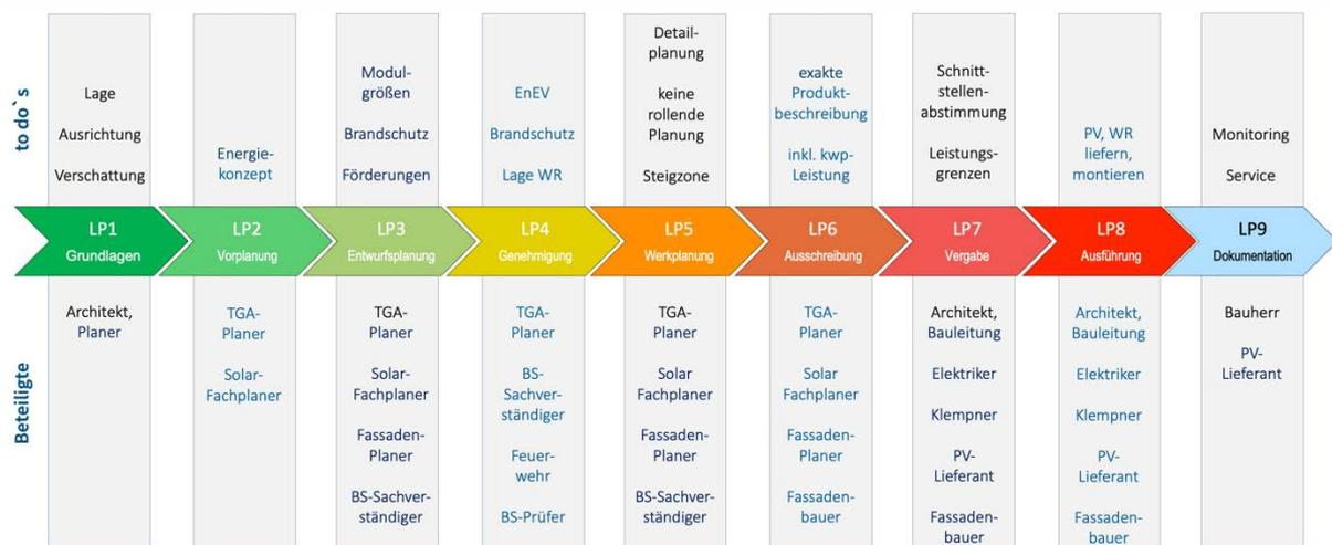
Abbildung 15: Fassadenintegration PV - Projektablauf (Quelle Allianz BIPV)
