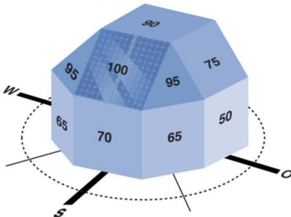
Abbildung 6: Prozentuale Strahlungsintensität nach Ausrichtung der Fläche (Quelle MGT-esys, Feldkirch/A)
