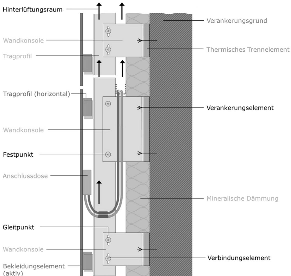
Abbildung 1: Systemgrafik der Vorgehängten Hinterlüfteten Fassade (Quelle FVHF)
