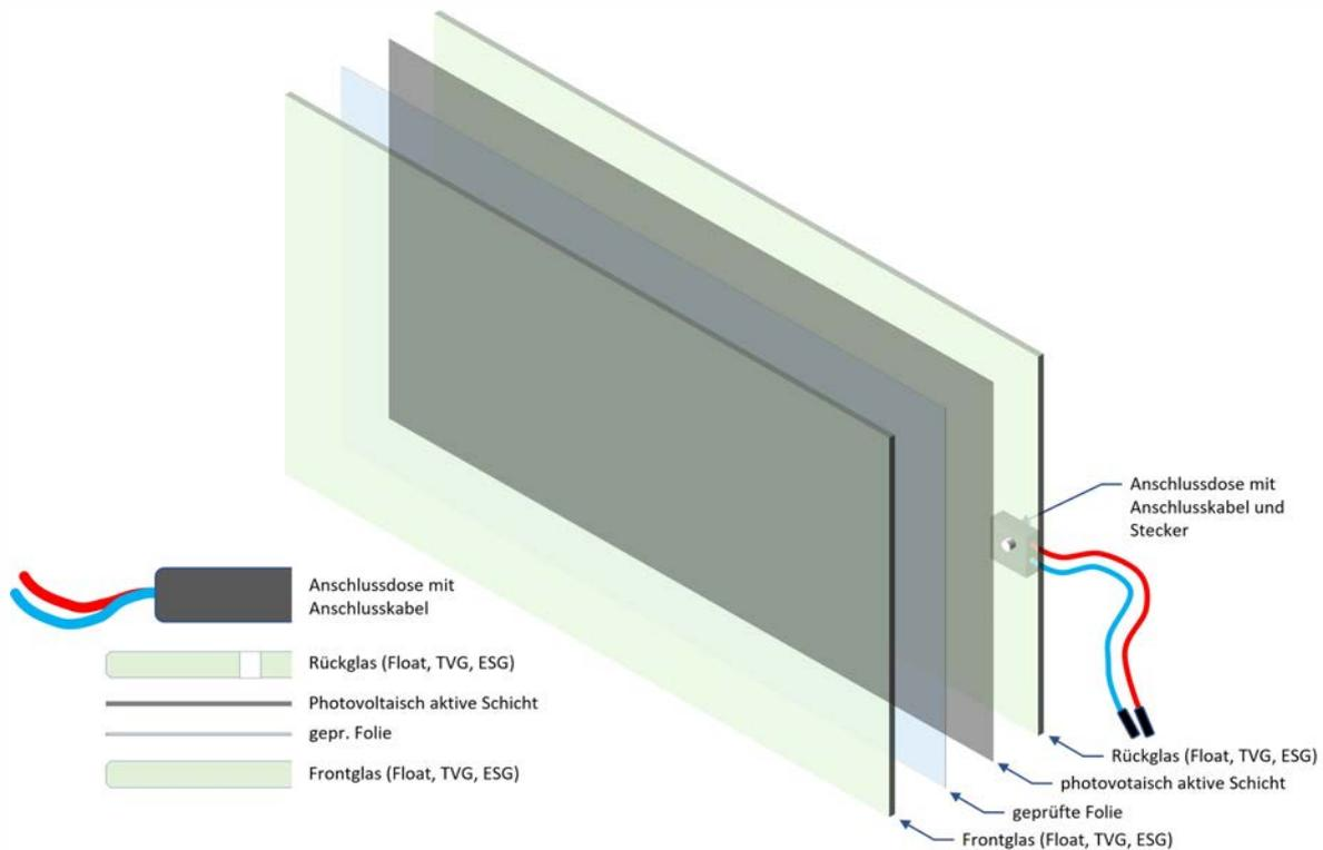
Abbildung 4: Aufbau Dünnschicht-Glas-Glas-Modul (Quelle FVHF)
