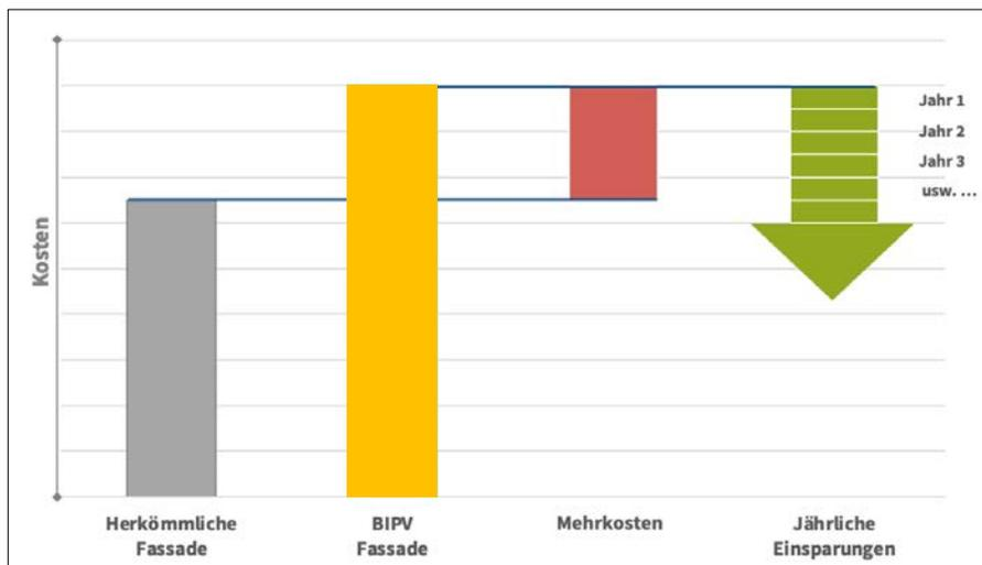
Abbildung 19: Amortisationsrechnung einer herkömmlichen Fassade <-> BIPV (Quelle FVHF)
