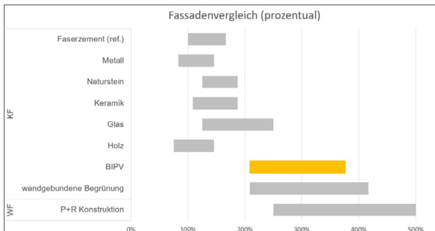
Abbildung 20: Basiswert dieser Tabelle ist eine sichtbar befestigte Faserzementfassade (Quelle FVHF)
