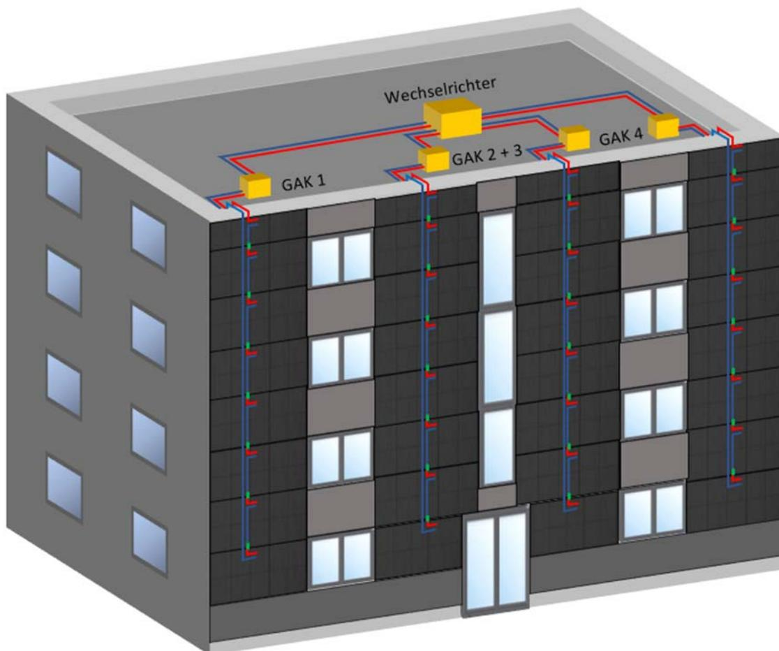
Abbildung 2: Schematische Darstellung der DC-Komponenten (Quelle FVHF)
