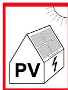
Abbildung 1: Kennzeichnung einer PV Anlage am Haus oder am Hauptzugang für die Feuerwehr, normale PV Anlage mit Netzspeisung
