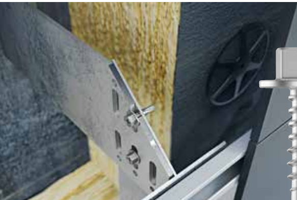
Der SDA5 kann sowohl überdreht im Gleitpunkt als auch im Festpunkt sicher montiert werden.
