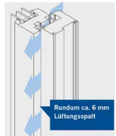
Beim Lüften mit Parallelabstellung stellt sich der Fensterflügel um einen Spalt von rund 6 Millimeter vom Rahmen ab.
