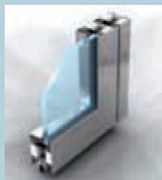
serie FERRO-WICLINE 70 plus und FERRO-WICSTYLE 70 plus. Geschlossenzellige Elastomerschaumkeder in der Dämmzone der Profile sowie eine koextrudierte Mitteldichtung bei den Fenstern ermöglichen eine Verbesserung des U-Wertes um 35% auf 1,3 bis 1,8 W/m<sup>2</sup>K. bk ◊
