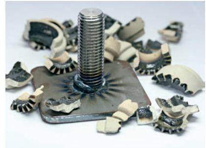
Die Firma Heinz Soyer räumt ein, dass das obere Foto (metallbau 03/2013) sachlich nicht richtig ist und verweist auf die richtige Darstellung unten: ein Schweißbolzen MR 16 mit Keramikring auf 10 mm Dickblech
