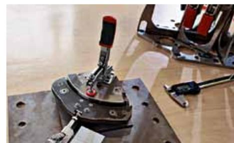
STC-VH50 gleicht 40 mm Spannhöhe aus
